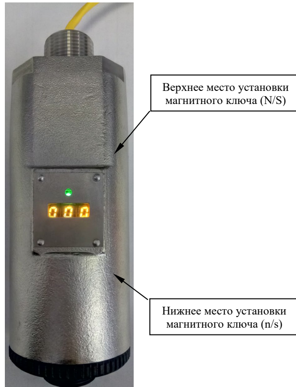
Рисунок 7 – Места установки магнитного ключа у ПГУ-А
